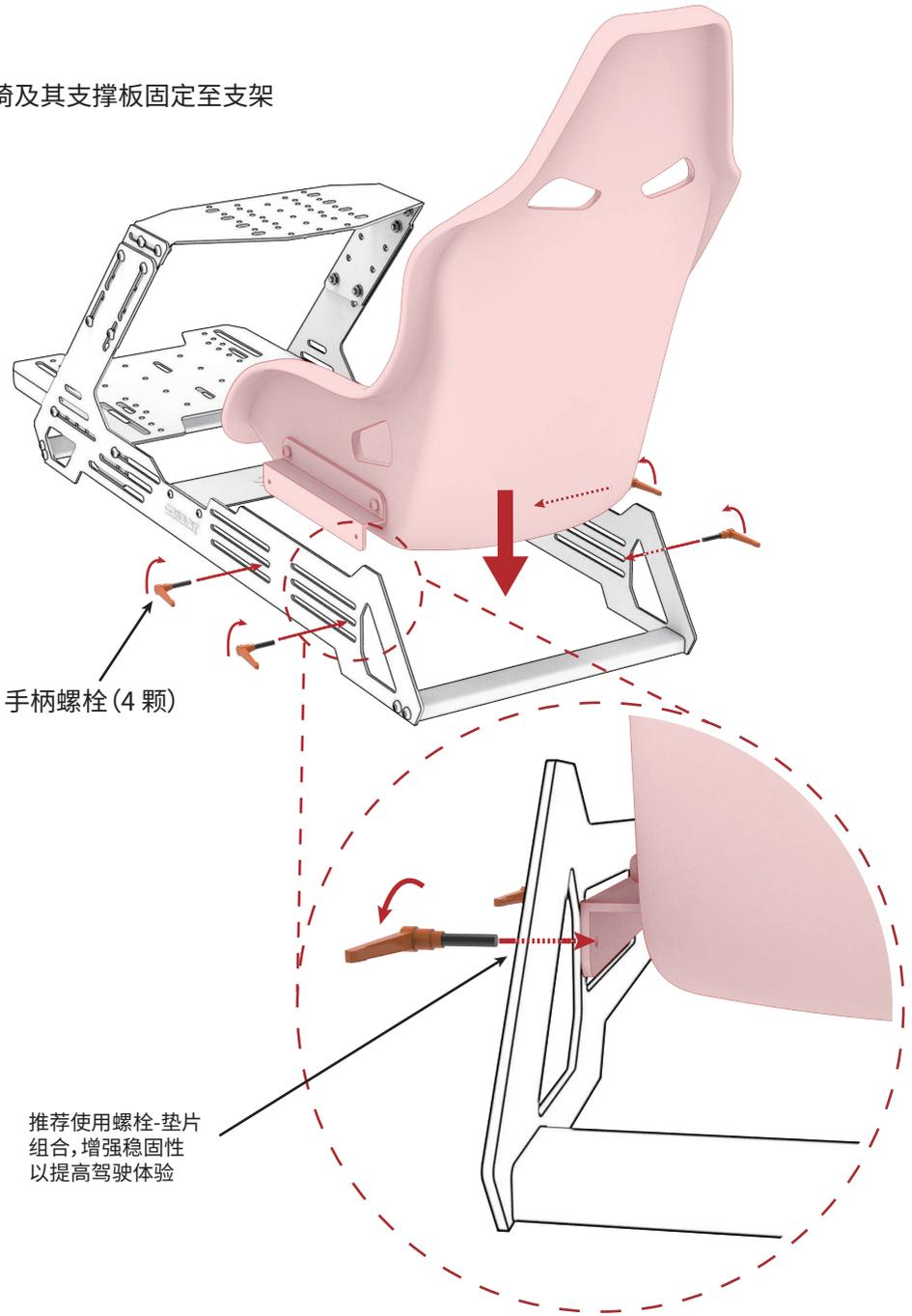
\*安装好座椅后, 将之前步骤的所有螺栓上紧
